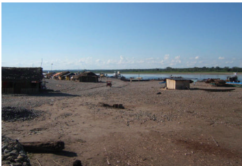
FotoN°3.2 Depósitos fluviales ubicado en el cauce del río Tambo, sector Puerto de Atalaya. Se observa depósitos de gravas en matriz compuesta de arenas y limos poco consolidados. Área susceptible de inundación.
