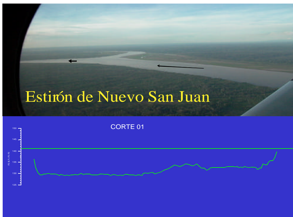
Figura N° 4.2 Sección 17. Estirón de San Juan: Se muestra una sección típica en un tramo recto de un río, donde la fuerza hidráulica es uniforme en toda la sección, con un tirante bastante pequeño y una anchura de sección normal.
