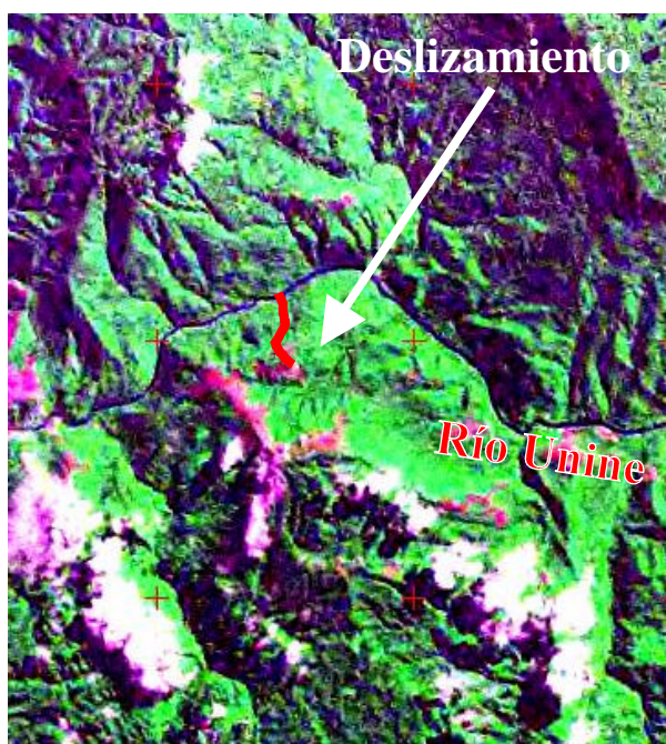
Figura N° 6.2 Sector de Unine (cuadrángulo de Obenteni) que muestra en su margen derecha un deslizamiento antiguo.
